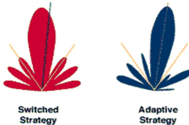
圖五：切換波束與適應性天線之波束場型示意圖
